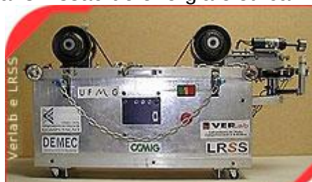
Figura 6 – Robô desenvolvido para instalação das esferas de segurança
